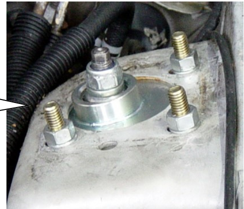
Eingebautes Federbein von unten. Installed coilover strut from below.
