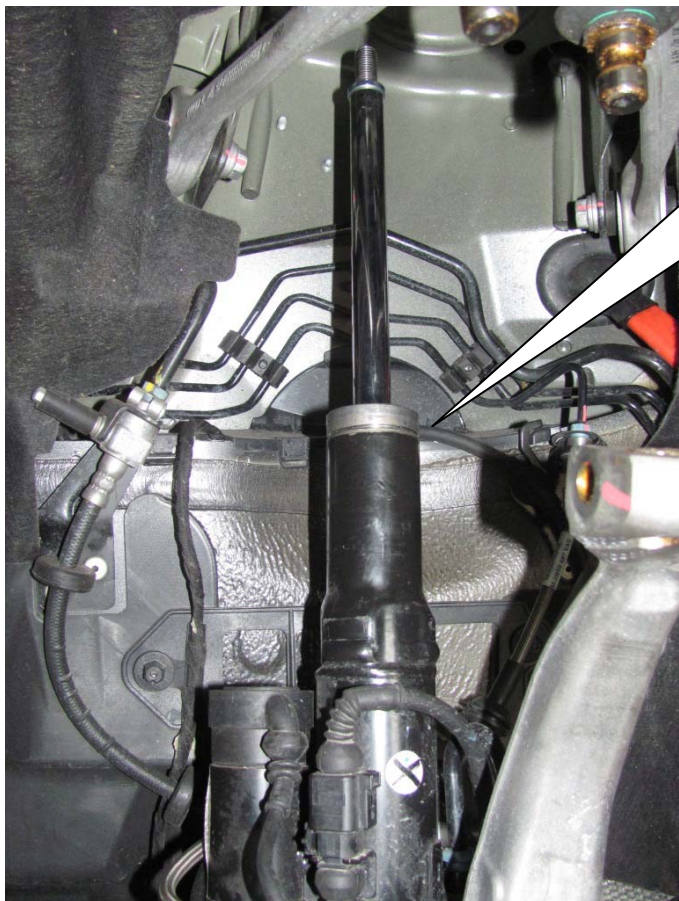
Komplett demontiertes Federbein. Dismantled coilover strut.
