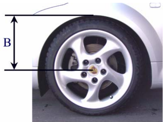
Abstandsmaß B - Radmitte - Kotflügelunterkante
