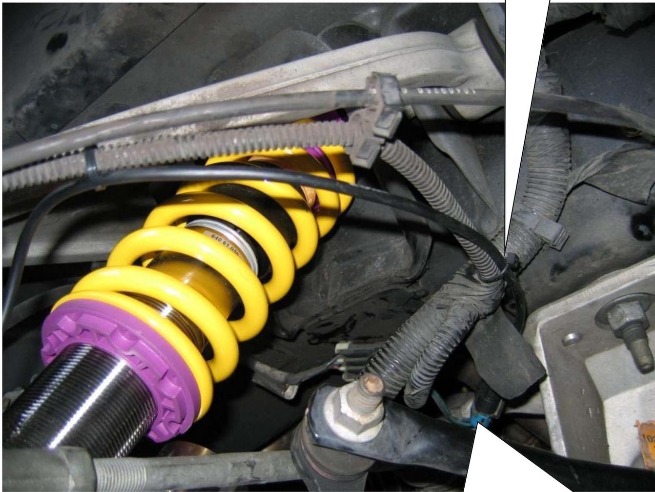
Originale Dämpfersteuerungsleitung in das mitgelieferte Elektronikbauteil einstecken. Auf die korrekte Verriegelung des Steckers achten! Anschließend originale Dämpfersteuerungsleitung mit Kabelbindern befestigen.
