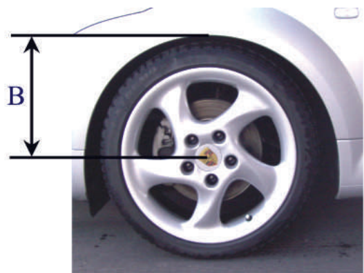
Abstandsmaß B - Radmitte - Kotflügelunterkante
