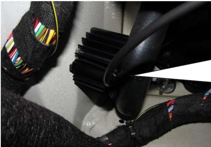
Stilllegungen mit den mitgelieferten Klebepads am Fahrzeug montieren. Adapterkabel in die Stilllegung sowie in den Originalstecker einstecken. Auf die korrekte Verriegelung des Steckers achten!
