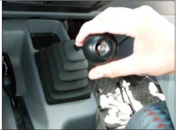
STEP 28. Install shift knob jam nut.
