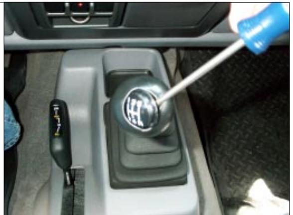
STEP 2. Remove stock shift knob jam nut.
