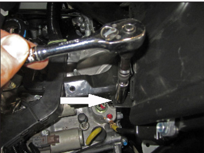
k. Remove the front top 10mm bracket bolt.
