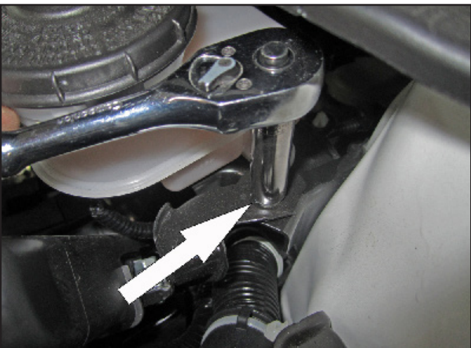
m. Remove the upper 10mm ECU bolt.
