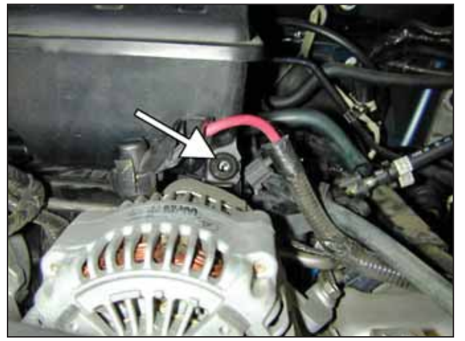
d. Loosen bottom right bolt.
