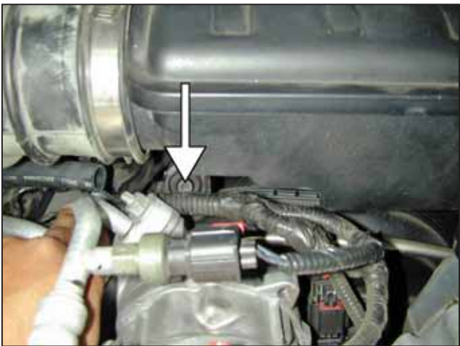
c. Loosen bottom left bolt.
